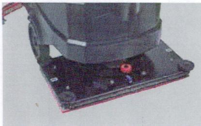
Orbitalscheuerdeck zur Bodenreinigung oder zum Entfernen der Nutzschicht (AS7190TO)
