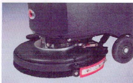
Werkzeugloses Entfernen und Anbringen der Saugleisten vereinfacht die Wartung
